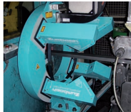
SPS 140-N4 Mesure des profilés ronds et des formes spéciales.
