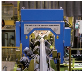
SPS 300-N4 Mesure le profilé complet de billettes rondes et carrées.
