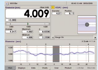
Laminage de barre ou processus similaires: diamètre moyen, résumés statistiques, graphique de la caractéristique
